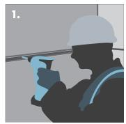
Fixing Knauf Perimeter Channel.
